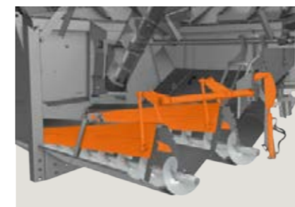
As chapas de cobertura acima dos sem-fim no piso do tanque de grãos controlam a velocidade de descarga em cinco posições.
